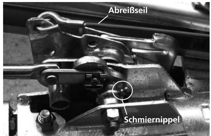
**Umlenkhebel Handbremse von der Unterseite des Anhängers gesehen**
