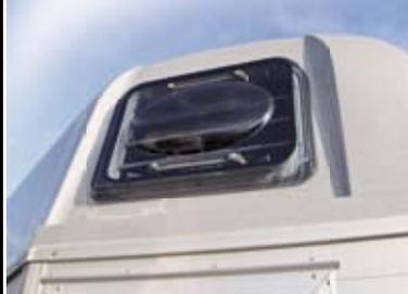
Fenêtres teintées réglables sur 5 positions avec barreaux de sécurité à l'intérieur
