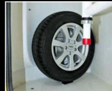
Roue de secours avec porte-roue monté dans la sellerie
