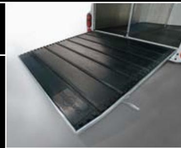
Tapis en caoutchouc avec lattes et arrêtoir latéral antidérapant
