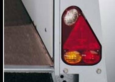
Lampes multifonctions de sécurité dans les renforts arrière
