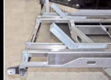
Deux rails de transport en aluminium réglables de 650 à 1 330 mm
