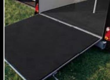
Hayon arrière assisté par ressorts à gaz, basculante et orientable, avec tapis en granulat de caoutchouc
