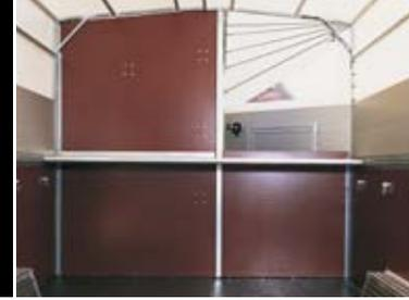
ISLAND Vue de l'intérieur avec parois latérales en aluminium anodisé et plancher en chape liquide
