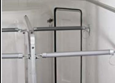
Bat-flanc central avec dispositif de verrouillage, barres de poitrail et barres de recul
