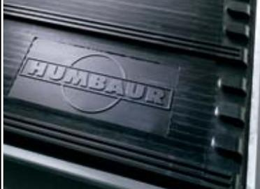
Tapis en caoutchouc sur le hayon arrière avec lattes et arrêtoir latéral antidérapant
