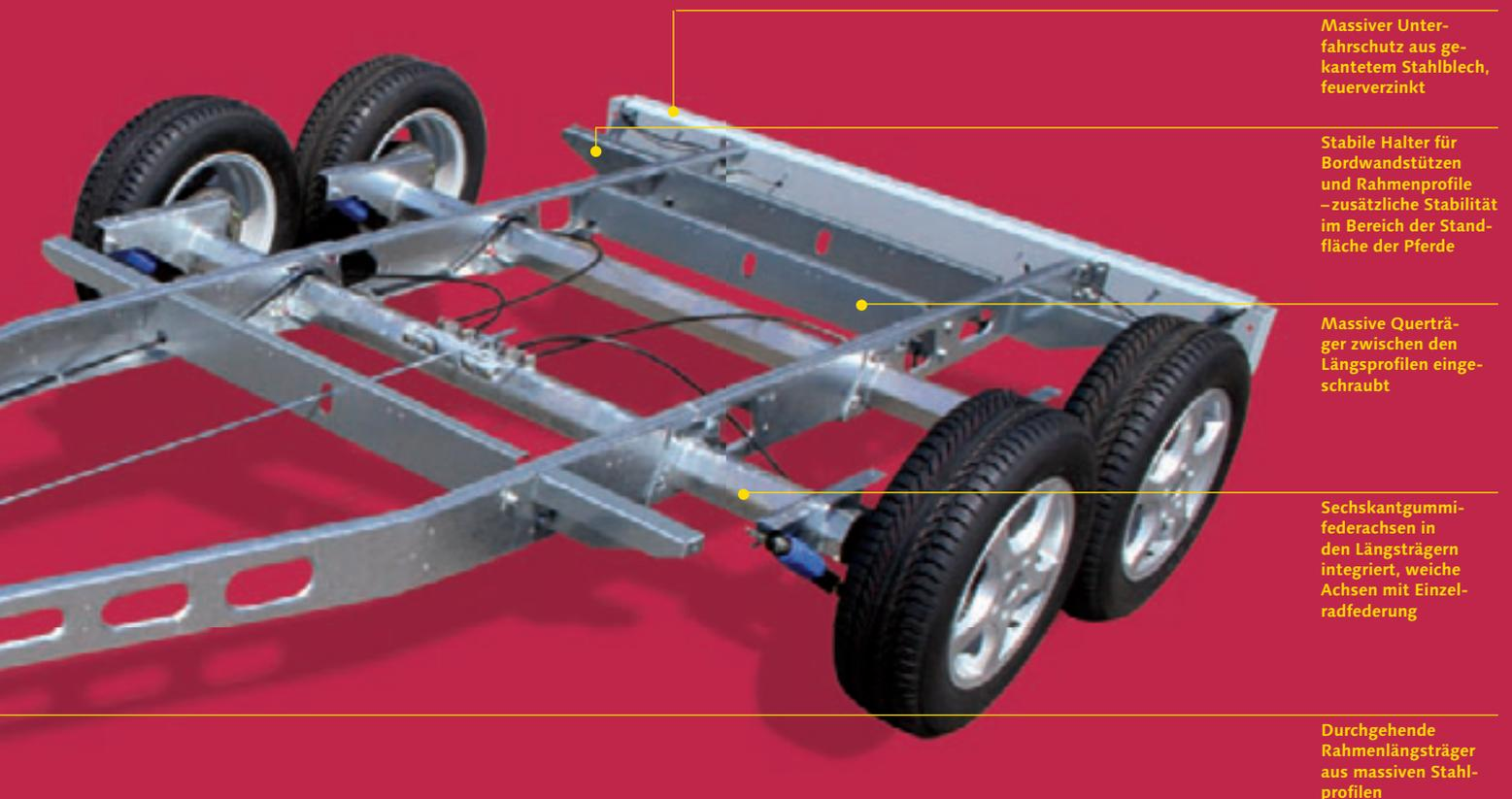
Massiver Unterfahrschutz aus gekantetem Stahlblech, feuerverzinkt
