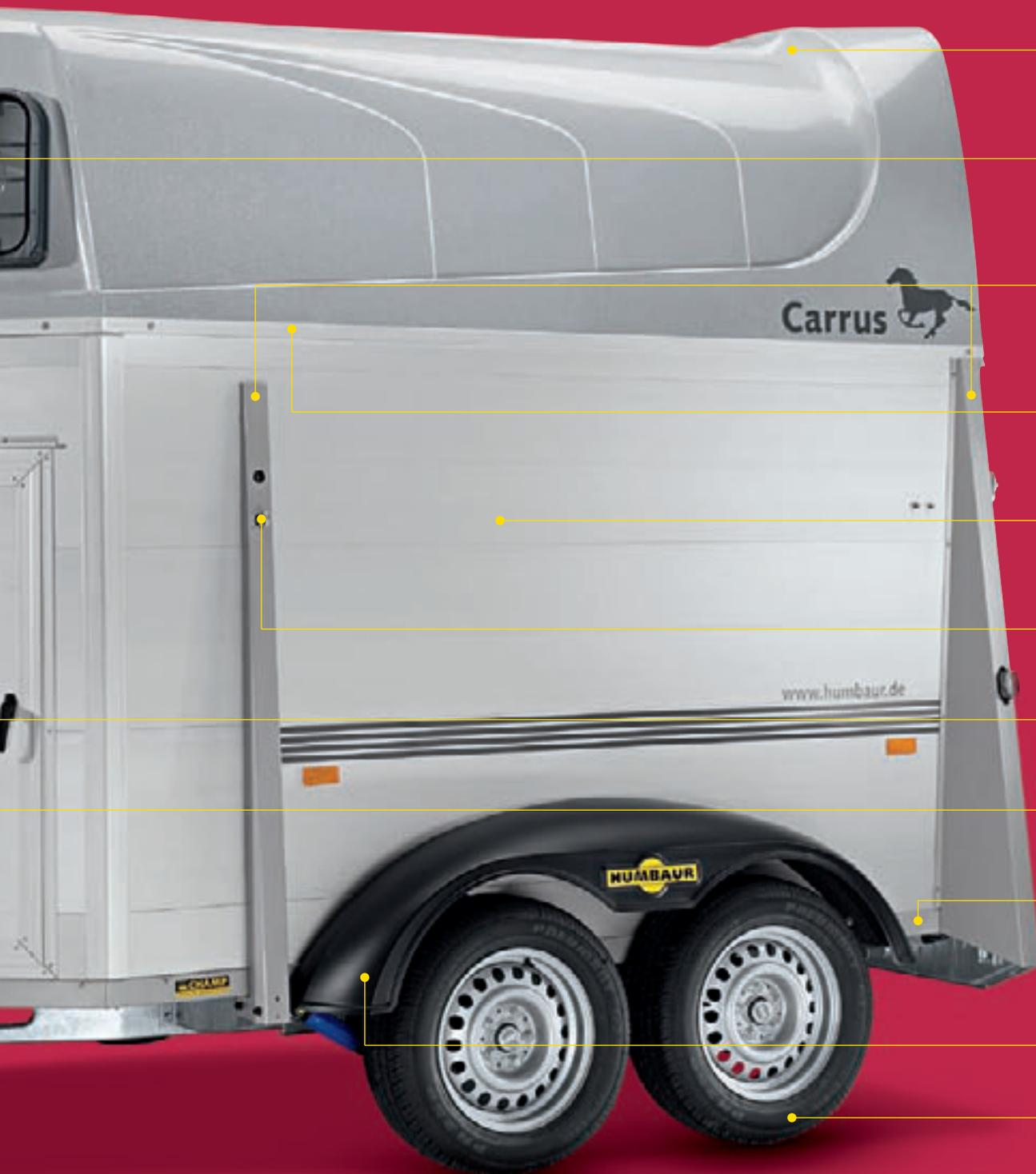
Polyhaube mit aerodynamischen Versteifungen in neuem Humbaur-Design
