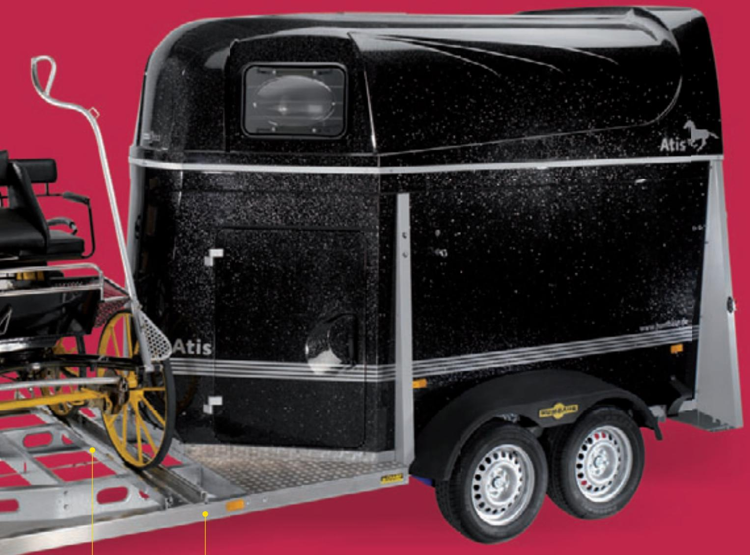
Verschiebbare Stand-schienen für die Kutsche, je nach Spurbreite von 650 mm bis 1330 mm
