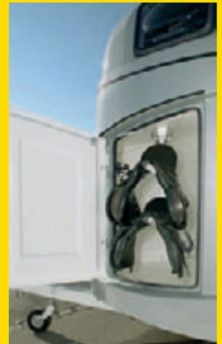
Der Pegasus ist serienmäßig mit einer großen, beleuchteten Sattelkammer ausgestattet. Der Sattelhalter ist auszieh- und schwenkbar. Die Tür wird mit einer abschließbaren Dreipunktverriegelung verschlossen.
