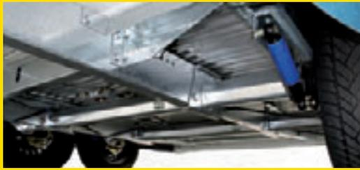
Der Anhänger-Boden besteht im Bereich der Sattelkammer aus Kunststoff, im Pferde-Standbereich aus Aluminium – dadurch ist eine Resistenz gegen Ammoniak gegeben, die wiederum eine hohe Lebensdauer des Anhängers garantiert.
