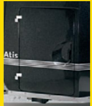
Große, abschließbare Sattelkammertür mit tief liegendem Verschlusshebel
