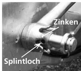
Ziehen Sie den Splint aus dem Hebel. Drehen Sie den Hebel, bis die Deichsel sich bewegen lässt, um die Höhe verstellen zu können. Heben oder senken Sie die Deichsel mit dem Griff an der Auflaufeinrichtung. Drehen Sie den Hebel bis er wieder fest ist und das Loch für den Splint durch die Zinken sichtbar ist. Stecken Sie den Splint durch die Öffnung. Nun können Sie den Anhänger ankuppeln.
