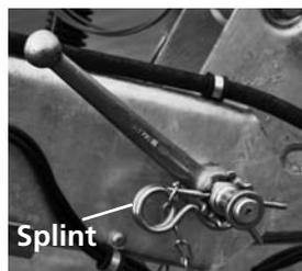
Hebel mit Splint und Ausschnitt Splintloch
